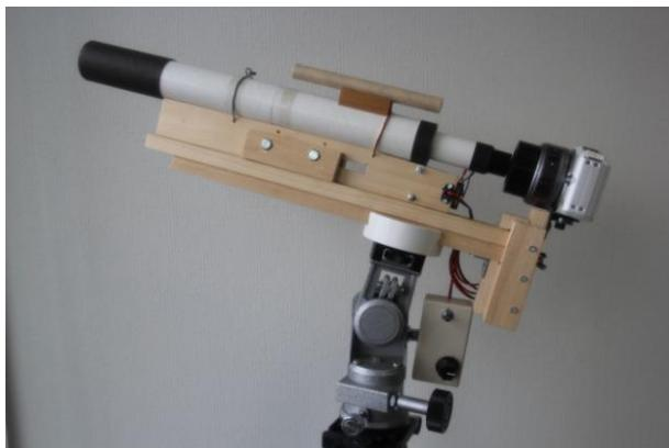
図2. 自作木製架台に取り付けたスピカ望遠鏡とミラーレス一眼レフカメラ
