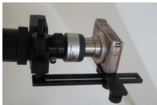
写真2. コンパクトカメラによるコリメート撮影 カメラは市販のデジカメラアダプターで固定
