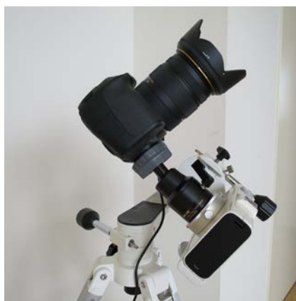
写真3. 経緯台に取り付けたコンパクト赤道儀 カメラは自由雲台を介して極軸上に固定
